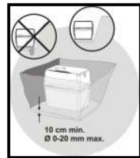
Figure 6-3-1 : Mise en fouille
