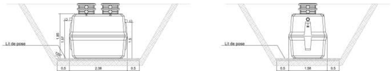
Figure 6-3-2 : Représentation théorique du placement d'un Greastop® C-90
