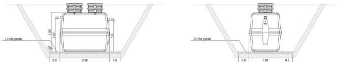
Figure 6-3-2 : Représentation théorique du placement d'un Greastop® C-90
