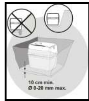
Figure 6-3-1 : Mise en fouille
