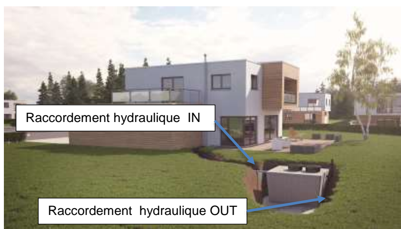
Fig-19 : Exemple de raccordement hydraulique pour une X-Perco® France C-90 5EH
