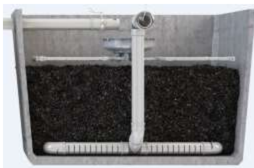
Fig-3 : Compartiment de traitement
