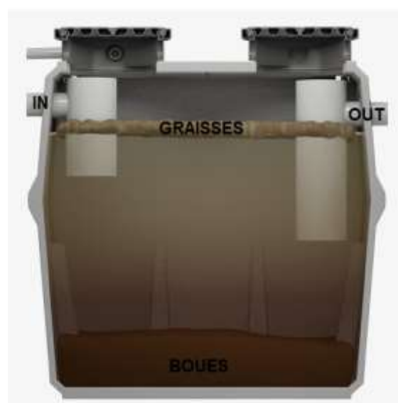
Figure 2-1 : Schéma de fonctionnement d'un Greastop® C-90.
