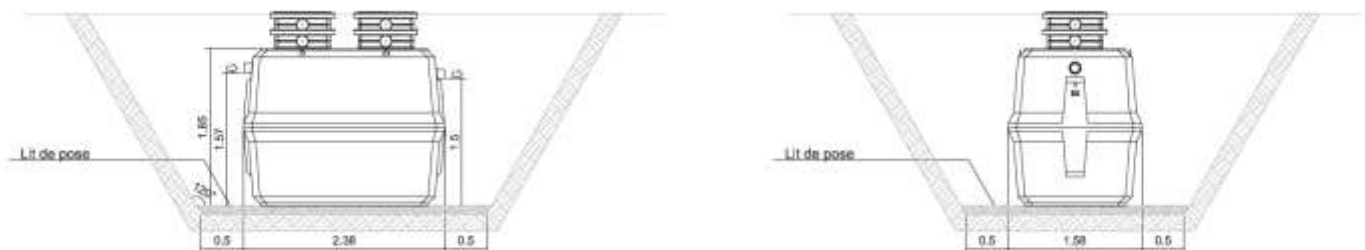
Figure 6-3-2 : Représentation théorique du placement d'un Greastop® C-90
